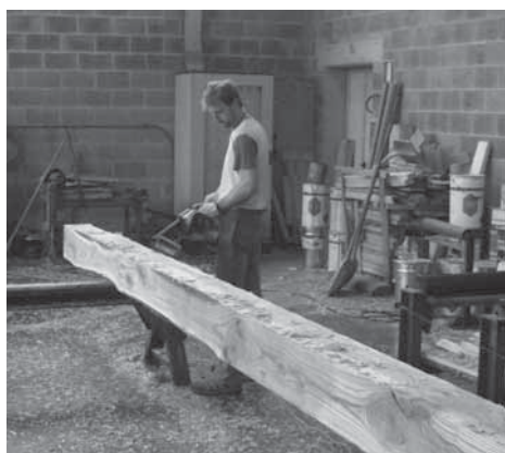
Fig. 2. Travi di castagno "Usò Fiume". Gli assortimenti vengono squadrati e successivamente piallati a mano con smusso fino alla punta, mantenendo una sezione costante. A sinistra, lavorazione effettuata con pialla a mano di travi in castagno "Usò Fiume" e, a destra, particolare di alcune sezioni con smusso
